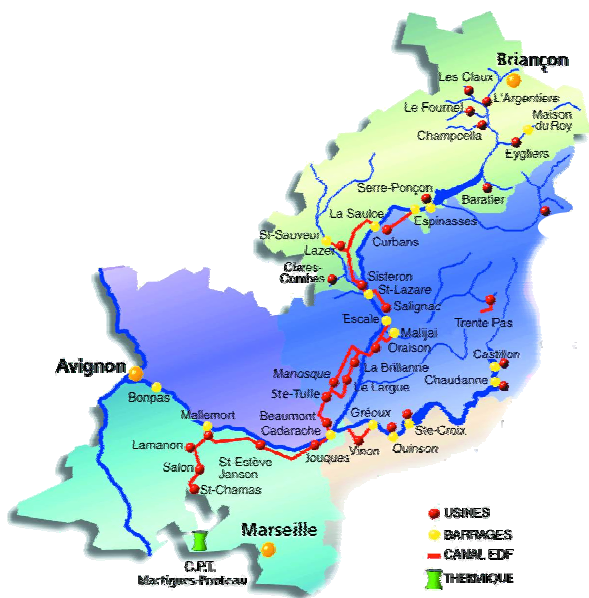
La chaîne hydroélectrique Durance - Verdon source EDF
